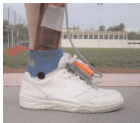
4 Turnschuhe mit Gyroskop.
